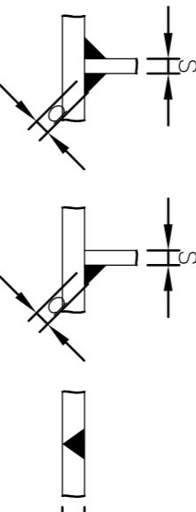
Dvojni kotni zvar      Kotni zvar      I in Vzvar
