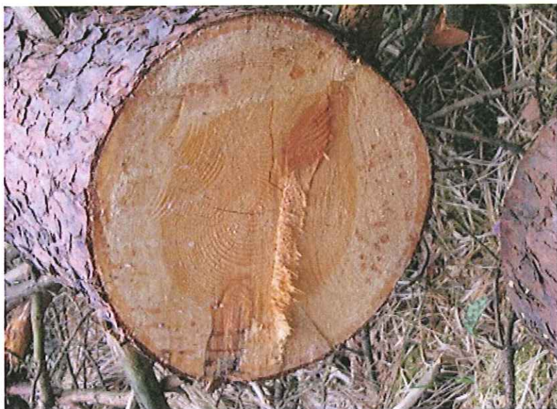
Slika 5: Borov hlood (peta hloda-spodnji konec hloda) z jasno razvidnim obarvanim srednjim delom (jedrovina) in zunanjim svetim delom (beljava)
