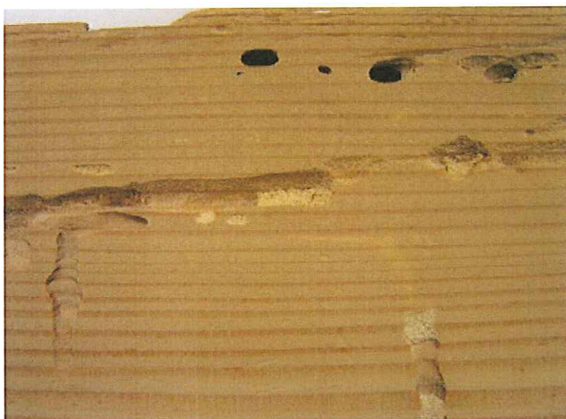
Slika 16: Poškodbe, značilne za hišnega kozlička. Ovalne izletne odprtine v beljavi iglavcev. Te poškodbe na drogovih niso dovoljene.
