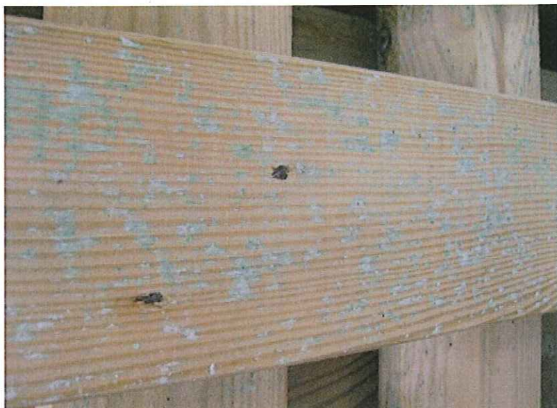
Slika 20: Neustrezna površina impregniranega lesa
