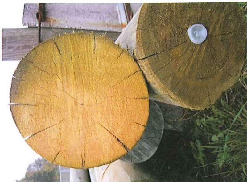
Slika 19: Neustrezno impregniran smrekov drog. Globina prodora ne dosega 6 mm.
