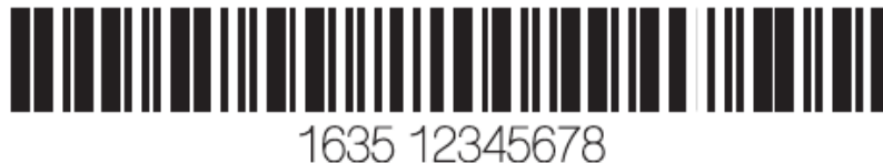
Slika 5: Zgradba črtne kode GS1-128
